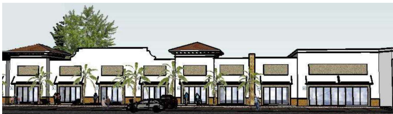
Figura 16 – Esemplificazione di finestre partizionate utilizzate sia come accessi che come vetrine
