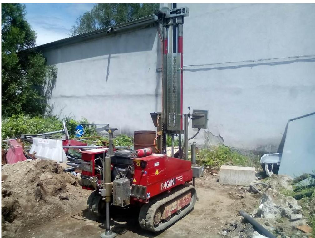
Figura 4-2 - Esecuzione della prova penetrometrica P2
