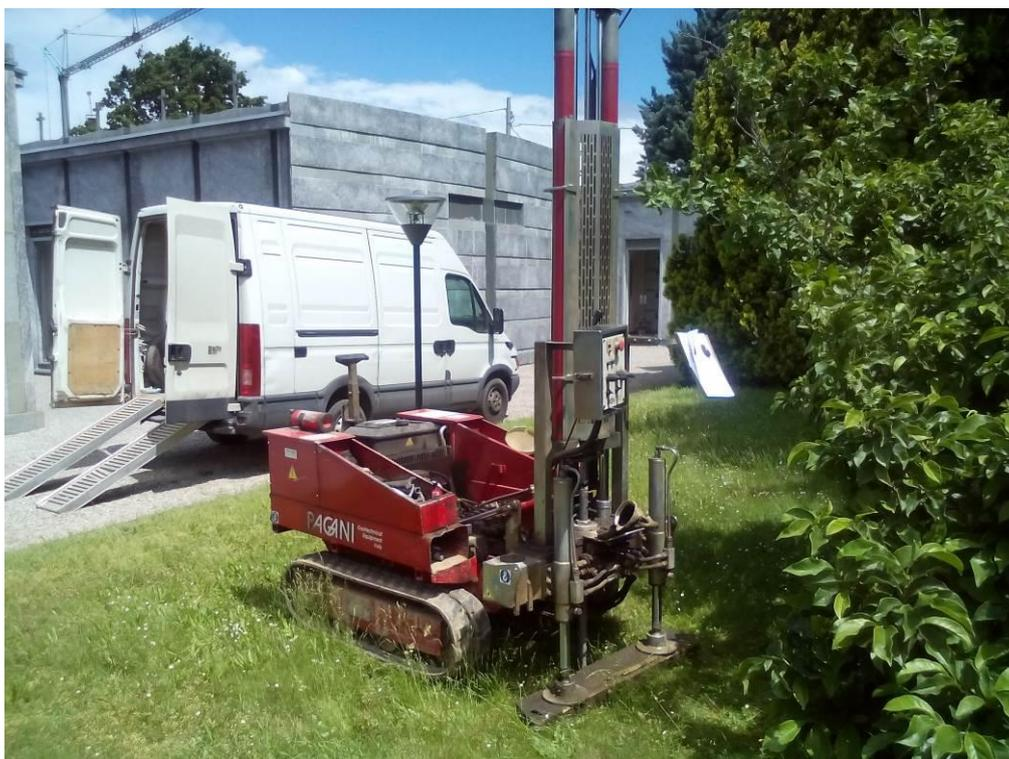
Figura 4-1 - Esecuzione della prova penetrometrica P1
