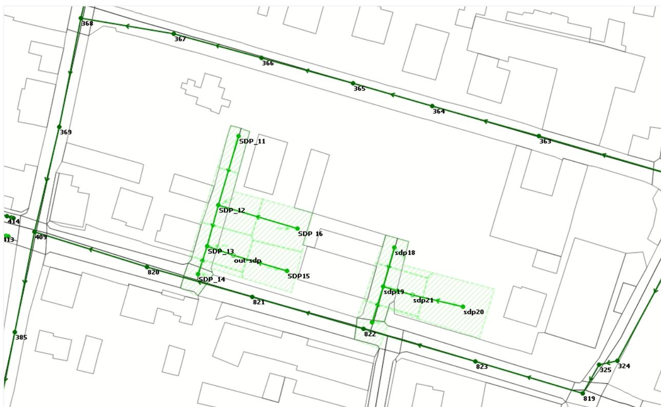
Fig. 2-7 - Nuove reti di drenaggio con dispersione nel sottosuolo, di Vicolo Kennedy (sx) e Via 28 Maggio (dx).
