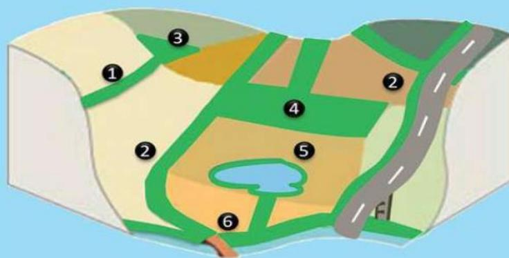
Rappresentazione schematica di un bacino idrografico e delle diverse tipologie di fascia tampone (Fonte: CORPEN / IRSTEA Modificato).
